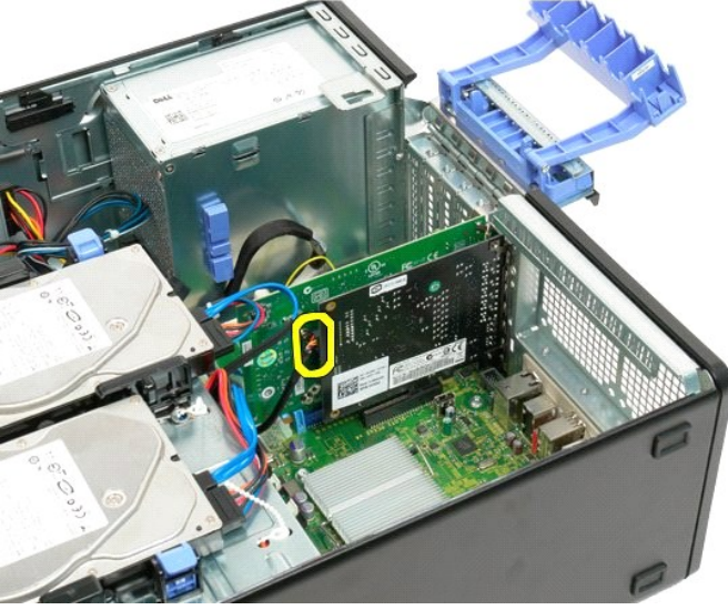
7. Genişleme kartını yukarı doğru düz şekilde çekin ve bilgisayardan çıkarın.
